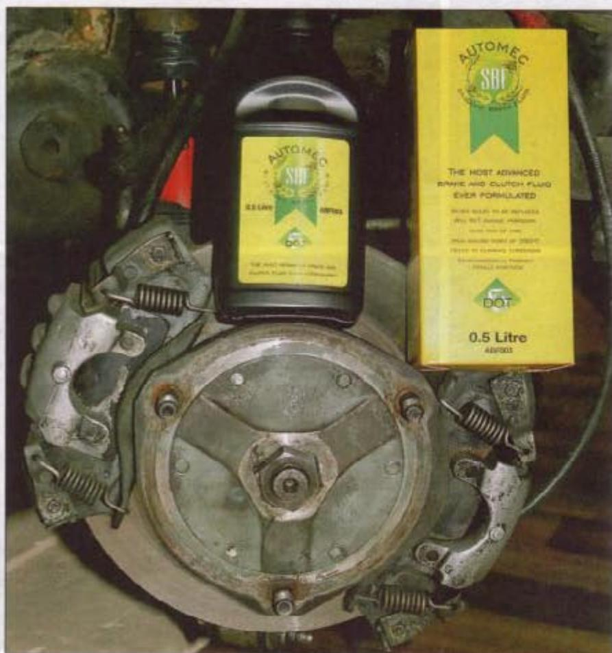
Pouvait-on trouver meilleur exemple pour ce sujet qu'une Panhard 24 BT ? Cette auto avant gardiste à bien des égards, possède pas moins de 6 étriers pour ses 4 freins à disques ! Revers de la médaille bien connu, les liquides de freins classiques induisent la corrosion des pistons et des cylindres avec des fuites, en particulier lors des remisages. Pour éviter ce problème commun à tous les collectionneurs, on a testé pour vous, le liquide de frein aux Silicones...
