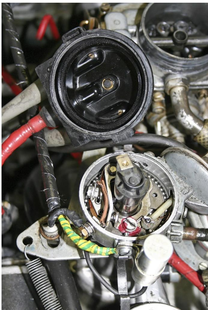
Les vis platinées ou les rupteurs devraient être en parfait état, en cas de doutes, les remplacer par des neuves. Tous les raccordements doivent être propres et bien serrés. Bien que l'assistance d'allumage électronique réduise fortement le courant qui passe par les rupteurs celui-ci demeure donc les vis platinées conservent toute leur importance !
