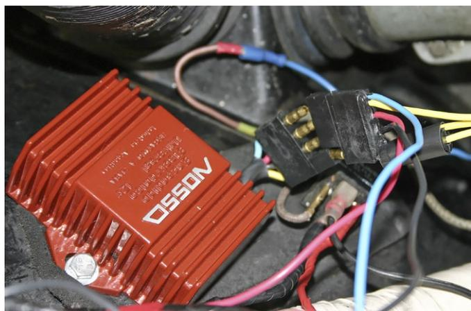
Si la bobine est équipée d'une résistance ou d'un fil résistif, le fil rouge doit être relié directement à un + 12 volts après contact. Veuillez vous reporter au NOTA en fin d'article pour déterminer votre cas. Le condensateur, le filtre antiparasites radio et le compte-tours, si présents, restent reliés comme avant. Vous pouvez en profiter pour les changer par précaution vu leur âge avancé...
